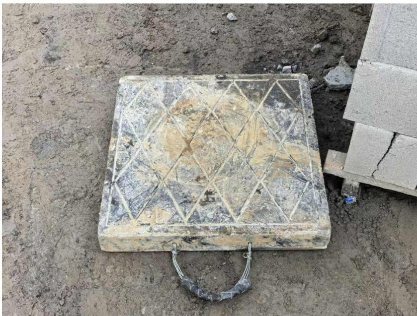
图 10 泵车应使用的随车配置的专用支撑块
