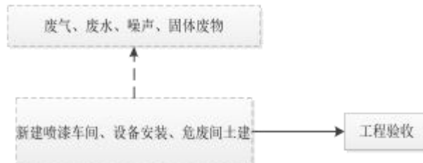
图 2-2 施工流程及产污节点示意图
