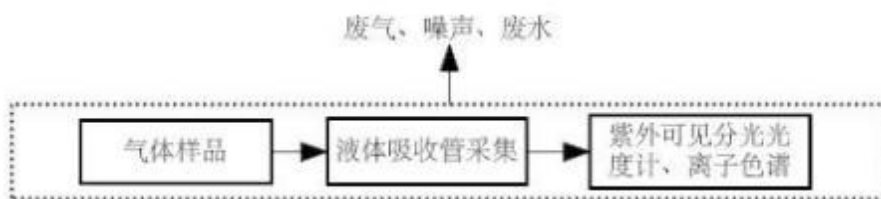
图 2-4 气体样品检测工艺流程及产污节点图
