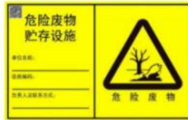
危险废物贮存场所的危险废物标签
